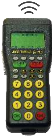
Ohjain ja näyttöpäätte Timy3 W Vaihtoehtona Timy3-WP varusteena lämpökirjoitin
